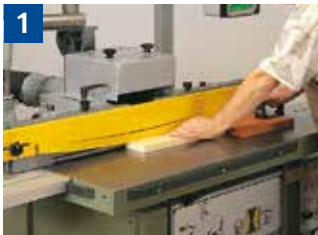
1 Handvorschub = Halten und Führen der Werkstücke von Hand
