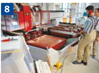
8 Mechanischer Vorschub = z. B. Arbeiten mit CNC-Bearbeitungszentrum
