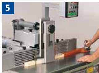
5 Fräsen von kleinen Werkstücken am Anschlag mit Druck- und Schutzvorrichtung und Schiebehholz
