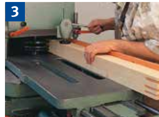
3 Handvorschub = Arbeiten mit dem Schiebeschlitten
