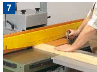
7 Fräsen von Querseiten mit durchgehendem Anschlag, Bogenfeder und Schiebehholz
