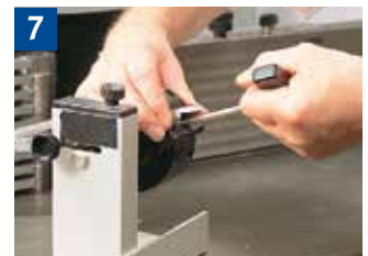
7 Lösen der Spanschrauben mit vorgegebenem Werkzeug (Imbusschlüssel)
