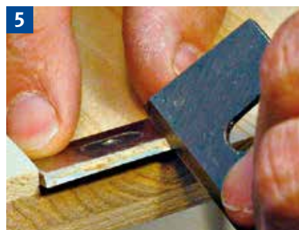
5 Achtung! Wendeplatten, Plattensitz und Spannkeil von Ablagerungen säubern, z. B. Harz- und Holzstaubablagerungen abschaben.
