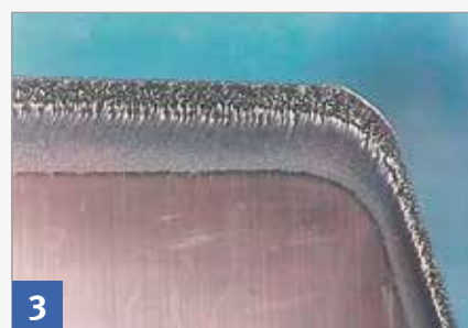
Chemischer Verschleiß bei einer Hartmetallschneide durch Holzinhaltstoffe
