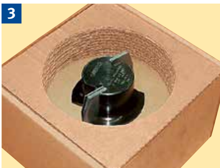
3 Werkzeuge mit Hartmetallwechscheln immer in der Originalverpackung transportieren.
