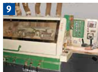
9 Mechanischer Vorschub = z. B. Arbeiten mit Mehrseiten-Hobel- und Fräsmaschine
