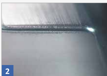
Physikalischer Verschleiß bei einer Stahlschneide
