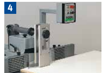
4 Fräsen von breiten Werkstücken am Anschlag mit Druck- und Schutzvorrichtung
