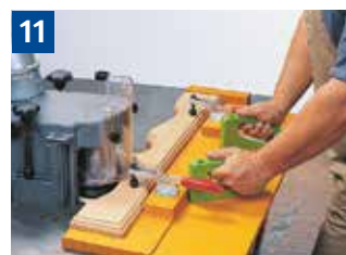
11 Fräsen von geschweiften Werkstücken mit Anlaufring und Bogenfräshaube
