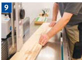
9 Einsetzfräsen großer Werkstücke mit Rückschlagsicherung Bilder: BGHM
