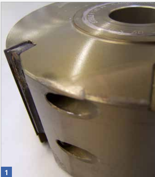
Durch Werkzeugsturz deformierter Aluminiumtragkörper
