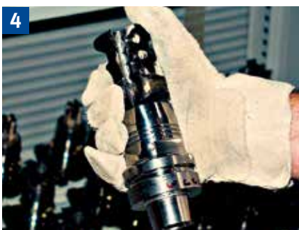
4 Beim Ein- und Ausbauen von Werkzeugen mit Hartmetallwechscheln die Hände mit Handschuhen oder einem Lappen schützen.
