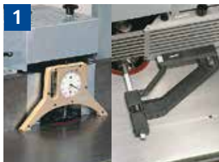
1 Einstellen von Fräshöhe und Frästiefe mit Messuhr
