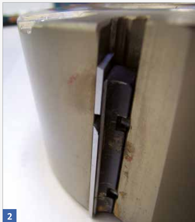
Durch Überlastung des Werkzeugs gebrochene Hartmetallschneide
