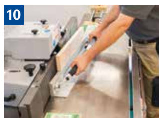
10 Einsetzfräsen kleiner Werkstücke mit Spannrolle und Rückschlagsicherung
