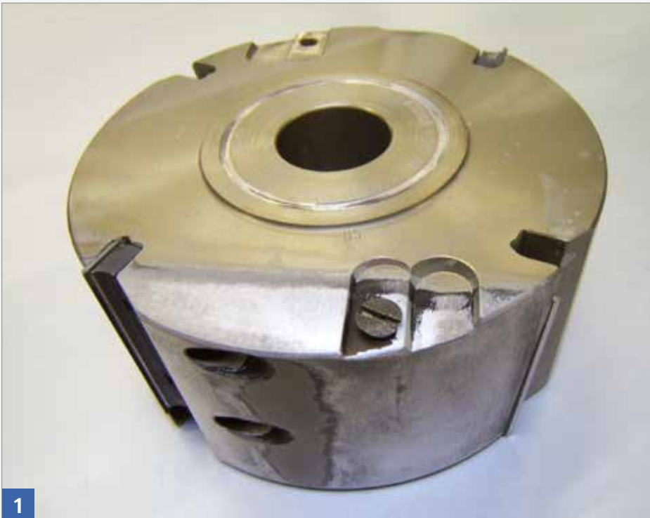
Durch Kaliumhydroxid angegriffenes Aluminiumwerkzeug
