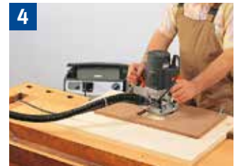
4 Handvorschub = Arbeiten mit Handmaschinen
