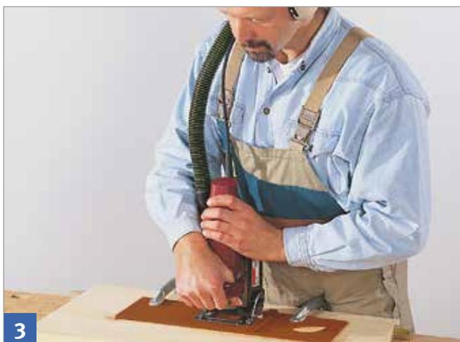
Beim Harzgallenausfräsen Maschine mit beiden Händen führen.
