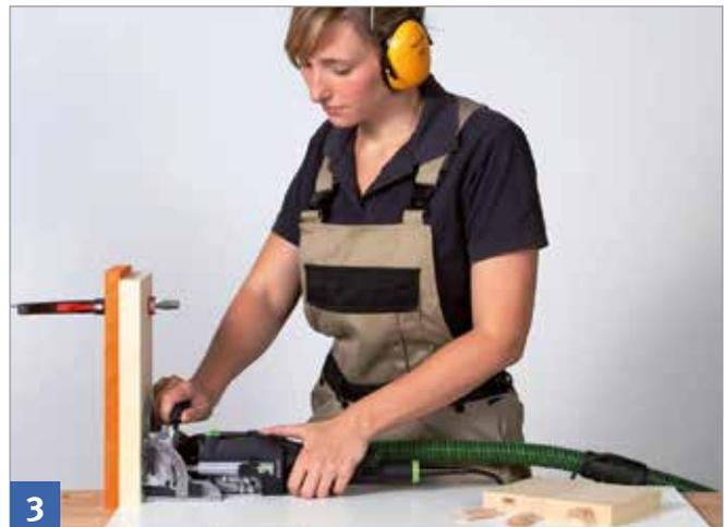
Werkstück bei stehender Bearbeitung durch Stützwinkel sichern.
