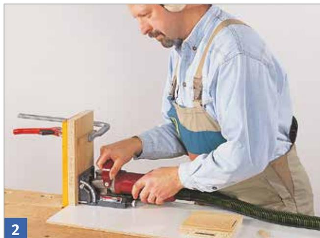
Werkstück bei stehender Bearbeitung durch Stützwinkel sichern.
