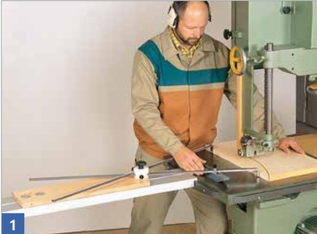
Segmentsägevorrichtung so anbringen, dass eine zur Bandsägeblattebene senkrechte, zwischen Zahnspitze und Zahngrund verlaufende Linie durch den Drehpunkt der Segmentsägevorrichtung geht.
