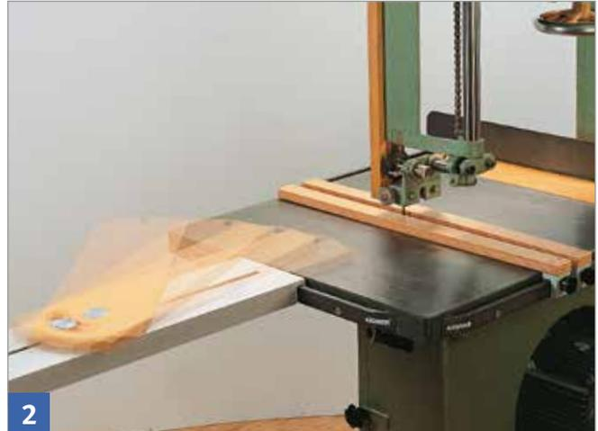
Kreissägevorrichtung anbringen und Fixpunkt (z. B. durch Dübel hergestellt) auf gewünschten Radius einstellen; der Fixpunkt/Drehpunkt muss mit der Zahngrundlinie des Bandsägeblatts fluchten.
