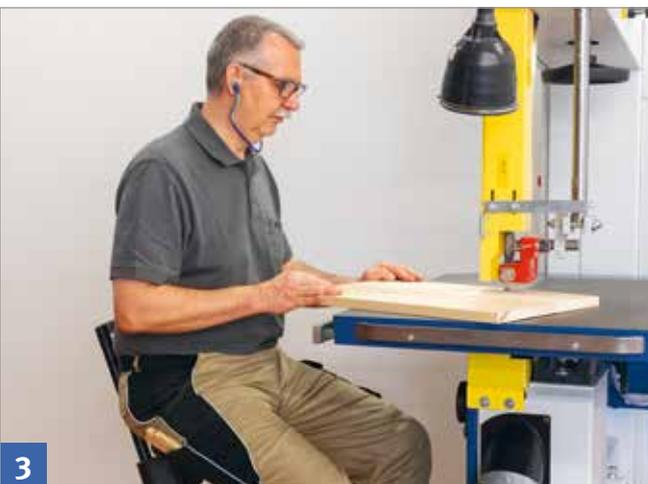
Zum Entlasten der Wirbelsäule eine Stehhilfe verwenden.
