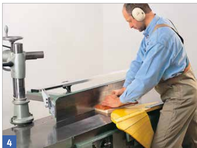
4 Zuführlade auf das Werkstück auflegen. Die Zuführlade mit beiden Händen am Griff, etwa 20° gegen die Vorschubrichtung gedreht, vorschieben.
