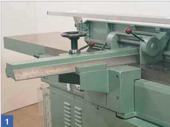
Anschlagführung ist gleichzeitig Messerwellenverdeckung.
