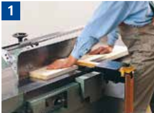
1 Abrichten breiter Werkstücke mit Schutzbrücke
