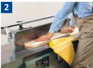
2 Abrichten breiter Werkstücke mit Gliederschwingschutz
