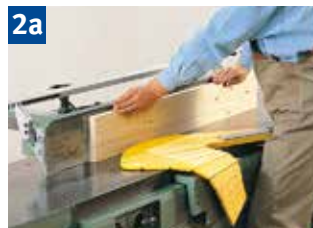
2a Fügen breiter Werkstücke mit Gliederschwingschutz
