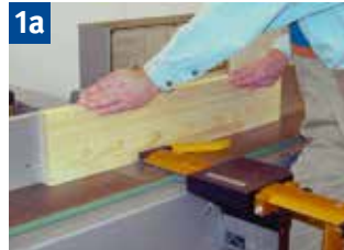
1a Fügen breiter Werkstücke mit Schutzbrücke
