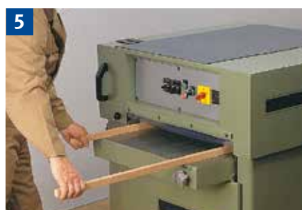
Hobeln schmaler Werkstücke. Bei starren Einzugs- und Druckrollen maximal zwei Werkstücke gleichzeitig bearbeiten.
