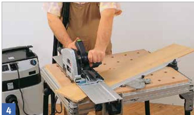
Für Montageschnitte beim Innenausbau geeignete Arbeitsvorrichtungen zur sicheren Werkstückauflage und präzisen Werkzeugführung benutzen.
