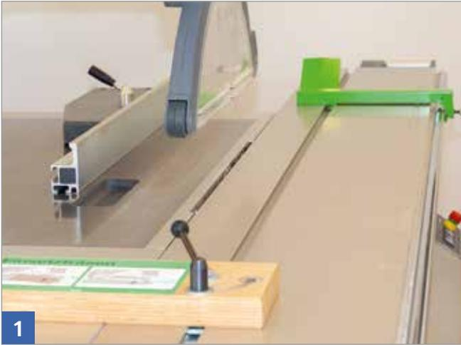
Spaltkeil entfernen, Spaltkeilhalterung festziehen.
