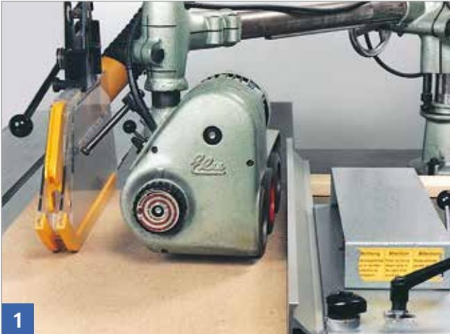
Schutzhaube mit Absaugung und Spaltkeil verwenden.
