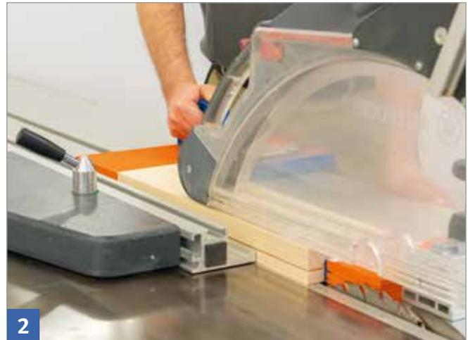
Fälzen mit der Sägehilfe. Parallelanschlag vor das Sägeblatt zurückziehen.
