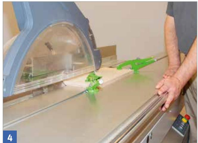
Schablonensägen mit Spannvorrichtung
