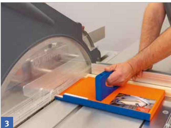
Absetzsägen mit der Sägehilfe. Das Werkstück wird am Winkelhilfsanschlag geführt. Das Abfallstück liegt nach dem Schnitt frei und kann nicht klemmen.
