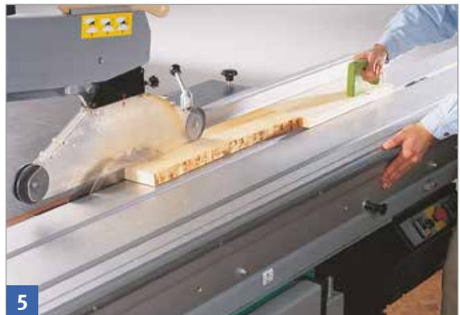
Erfahrungsgemäß muss wegen der Schutzhaubenbreite bei sehr schmalen Werkstücken (Breite 30 mm und weniger) ein Schiebehholz verwendet werden.
