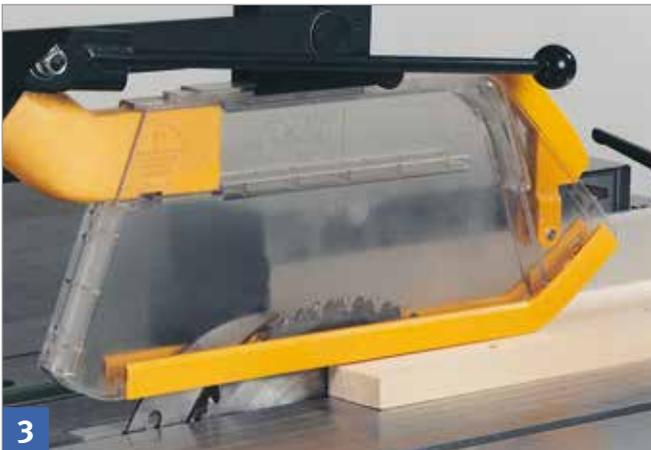
3 Getrennt befestigte Schutzhaube auf Werkstückdicke einstellen oder auf Maschinentisch absenken.
