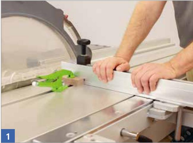
1 Spannen eines kleinen Werkstücks vor dem Queranschlag
