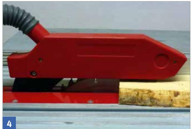
4 Wenn die obere Werkzeugverdeckung am Spaltkeil befestigt ist, soll der Abstand zwischen Werkzeugverdeckung und Werkstückdicke möglichst gering sein.
