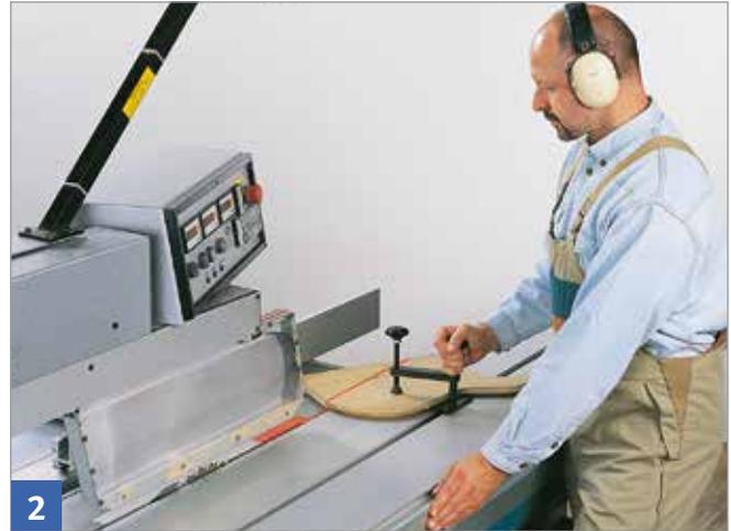
... wenn vorhanden, am Laserstrahl ausrichten und Schablonenplatte auf den Schiebetisch spannen.
