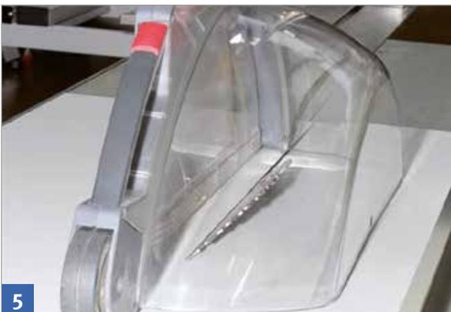
5 Bei schräg gestelltem Sägeblatt breite Schutzhaube verwenden.
