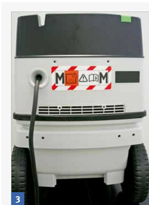
Möglichst Staubsauger mit eingebauter „Automatiksteckdose“ verwenden, der sich automatisch mit der Handmaschine ein- und ausschaltet. Als transportable externe Absaugeinrichtungen dürfen nur geprüfte Industriestaubsauger oder Kombigeräte (Kombination aus Entstauber und Industriestaubsauger) verwendet werden.
