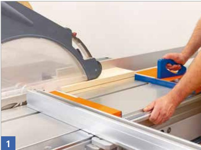
Fälzen mit der Sägehilfe. Das Abfallstück ist links vom Sägeblatt und wird von der Sägehilfe bis hinter die Schutzhaube mitgeführt.
