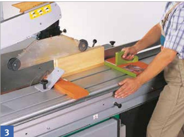
Vordere und hintere Sägehilfe einsetzen.
