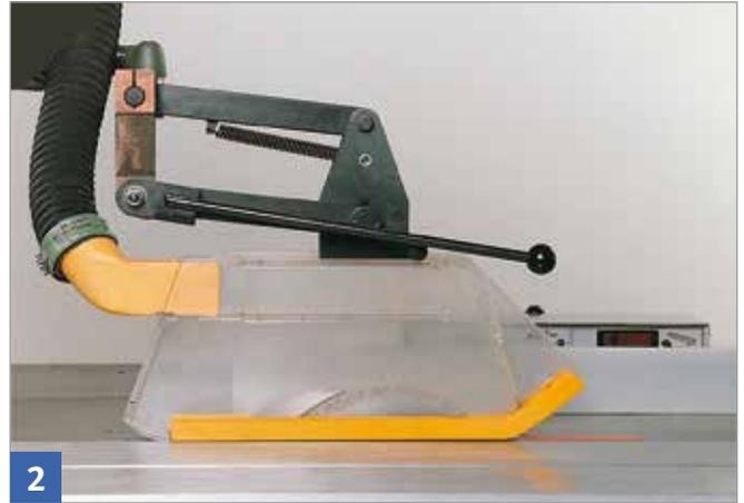
2 Spaltkeil und Schutzhaube mit Absauganschluss bei den Arbeitsgängen verwenden.
