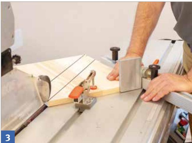
3 Spannen eines Werkstücks zum Winkelsägen
