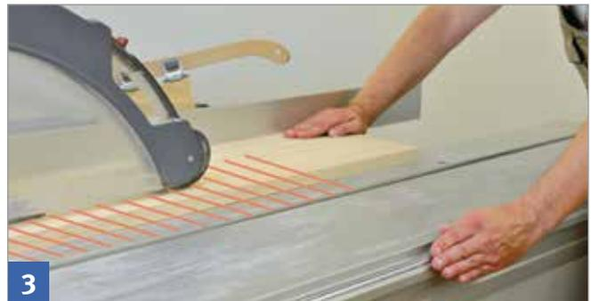
anschließend linke Hand an den Maschinentisch anlegen.
