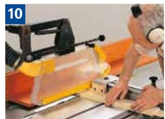
10 Schutzeinrichtung und Handhaltung beim Absetzen von Zapfen
