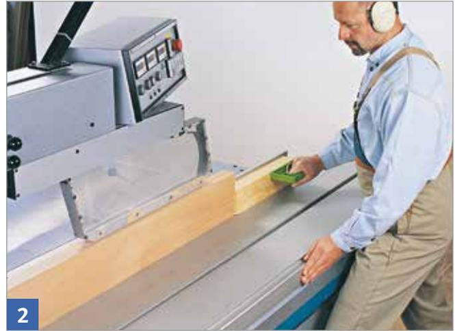
Ragt das Sägeblatt über die Oberkante des Parallelanschlags hinaus, ist eine sichere Werkstückführung nicht gewährleistet. Deshalb muss ein hoher Hilfsanschlag verwendet werden.
