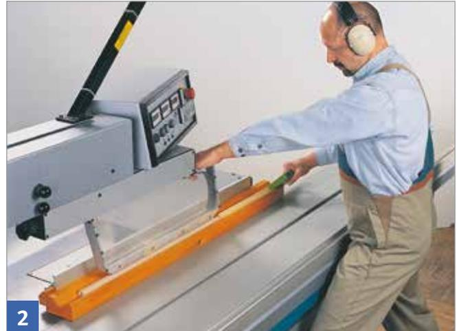
Vorrichtung (z. B. Winkelbrett) am Parallelanschlag befestigen.
