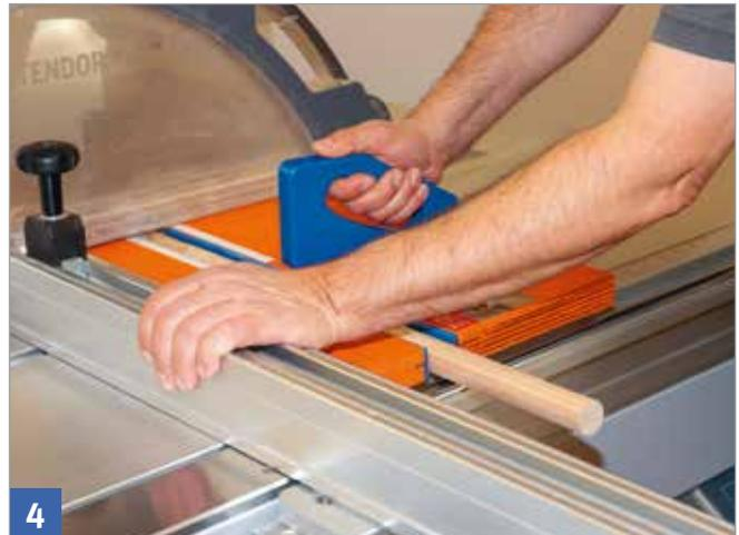
Halten und Führen kleiner schmaler Werkstücke mit der Sägehilfe
