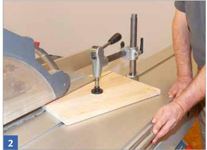
2 Spannen eines Werkstücks ohne Anschlag
