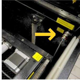
2. Rundgraviereinheit vorne rechts anschließen (Motor zeigt nach rechts)
